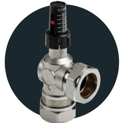
Aufgrund der zunehmenden Druckunterschiede öffnet sich die Klappe im Druckdifferenzregler, wodurch ein zu starkes Absinken des Wasserkreislaufs in der Zentralheizungsanlage verhindert wird. Außerdem sorgt der Druckdifferenzregler dafür, dass störende Geräusche verhindert werden und die Pumpe des Heizungskessels nicht überlastet wird, weil ein ausreichender Durchfluss vorliegt.
